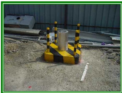
照片 4-1 標準式地下水監測井
